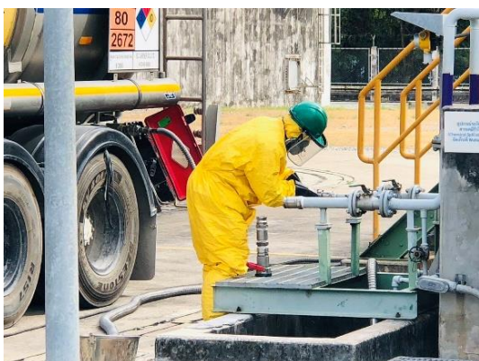
ภาพที่ 2-31 การสูบน้ำแอมโมเนียมไฮดรอกไซด์เหลว
