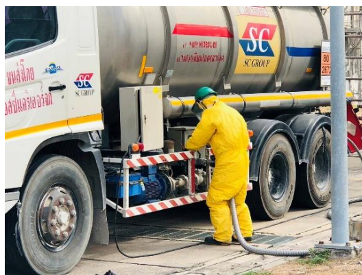
ภาพที่ 2-31 การสูบน้ำแอมโมเนียมไฮดรอกไซด์เหลว
